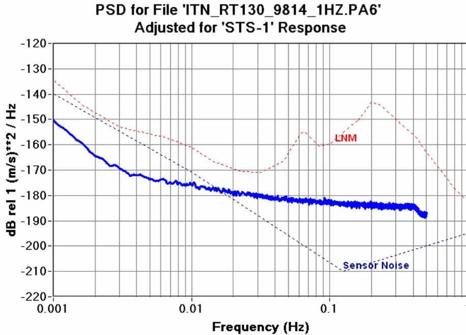
Figure 6.12.13c RT130HR 1SPS CH6 Seismic System Noise STS-1
