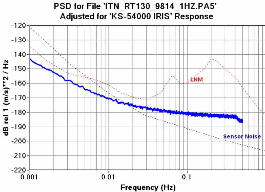
Figure 6.12.14b RT130HR 1SPS CH5 Seismic System Noise KS54000
