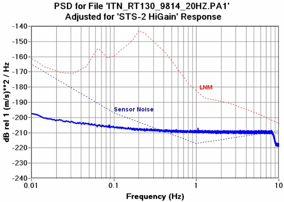
Figure 6.12.7a RT130HR 20SPS CH1 Seismic System Noise STS-2 High Gain
