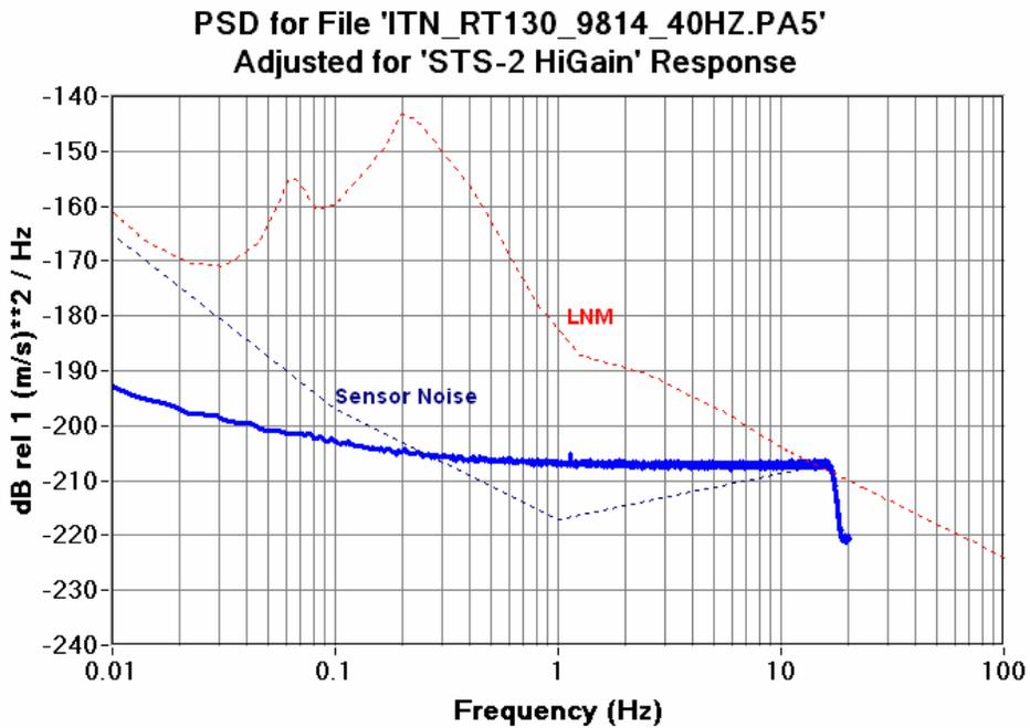
Figure 6.12.6b RT130HR 40SPS CH5 Seismic System Noise STS-2 High Gain
