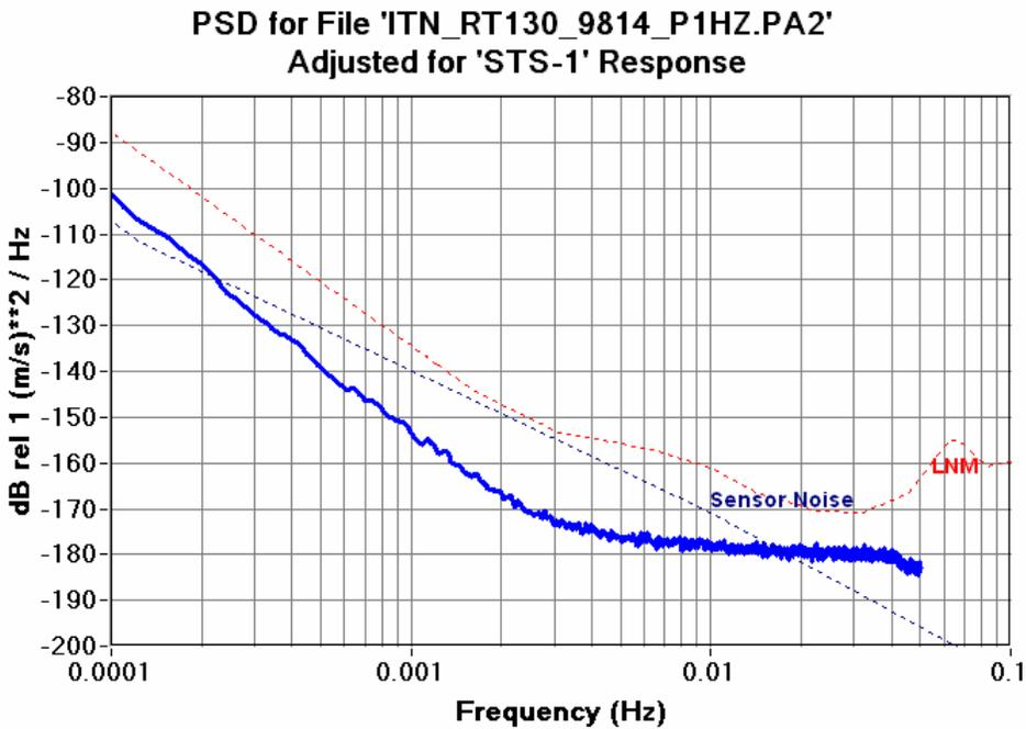
Figure 6.12.16b RT130HR 0.1SPS CH2 Seismic System Noise STS-1
