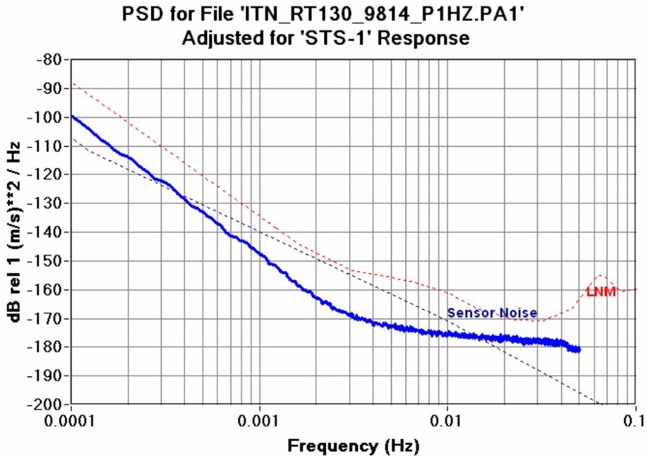
Figure 6.12.16a RT130HR 0.1SPS CH1 Seismic System Noise STS-1
