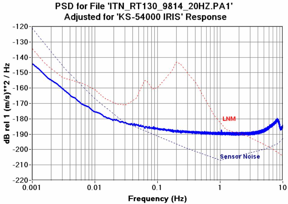
Figure 6.12.10a RT130HR 20SPS CH1 Seismic System Noise KS54000
