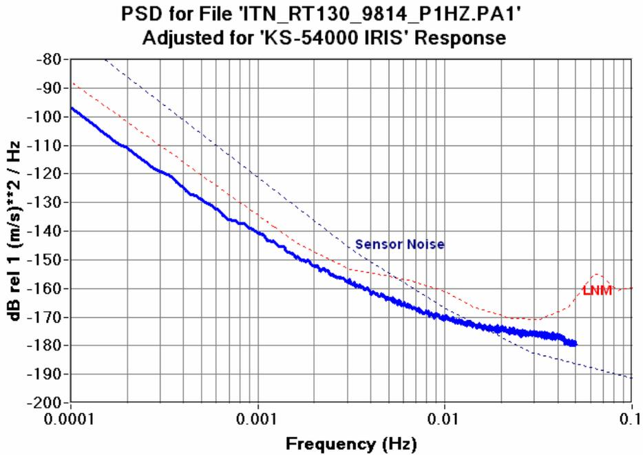
Figure 6.12.17a RT130HR 0.1SPS CH1 Seismic System Noise KS54000
