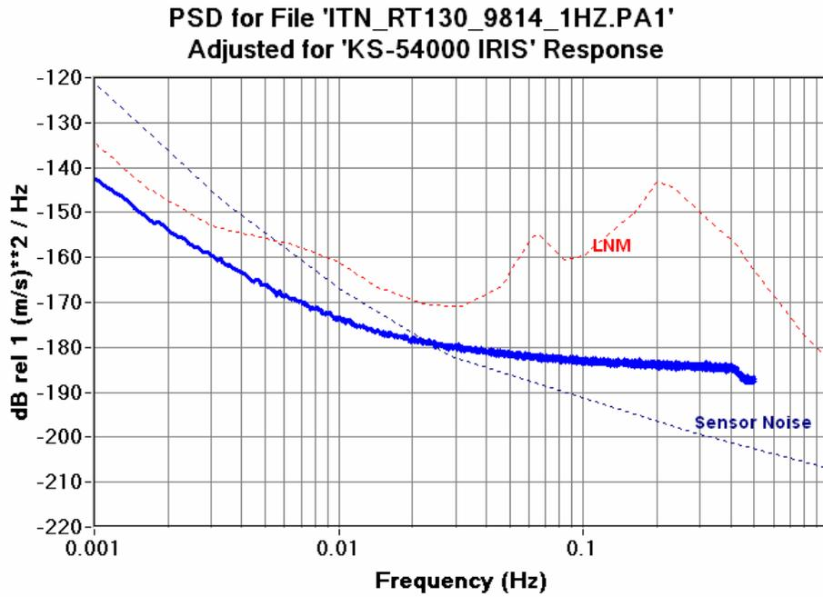
Figure 6.12.12a RT130HR 1SPS CH1 Seismic System Noise KS54000
