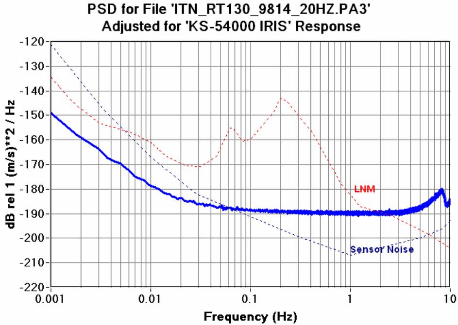
Figure 6.12.10c RT130HR 20SPS CH3 Seismic System Noise KS54000
