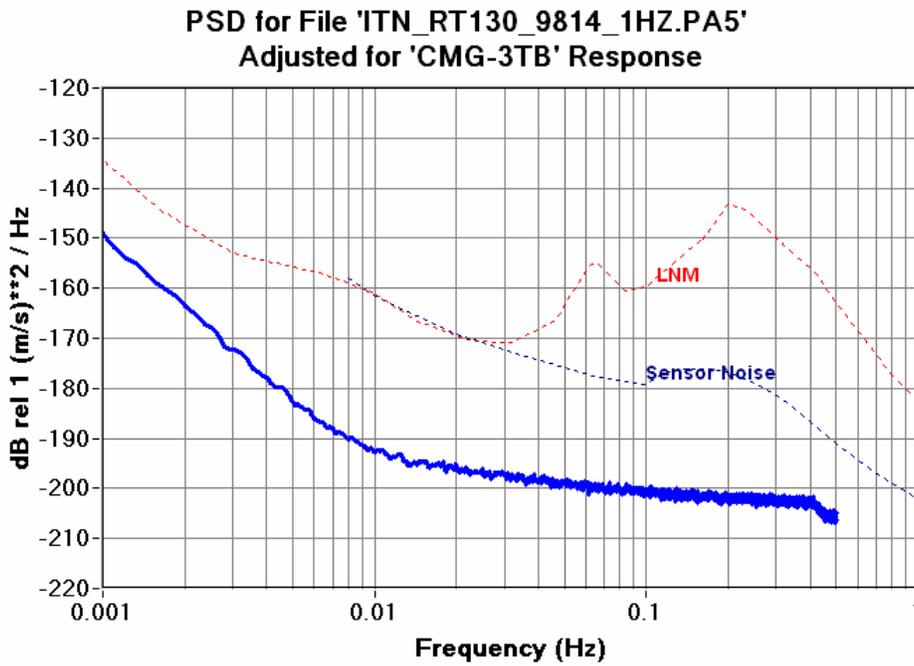
Figure 6.12.15b RT130HR 1SPS CH5 Seismic System Noise CMG-3TB
