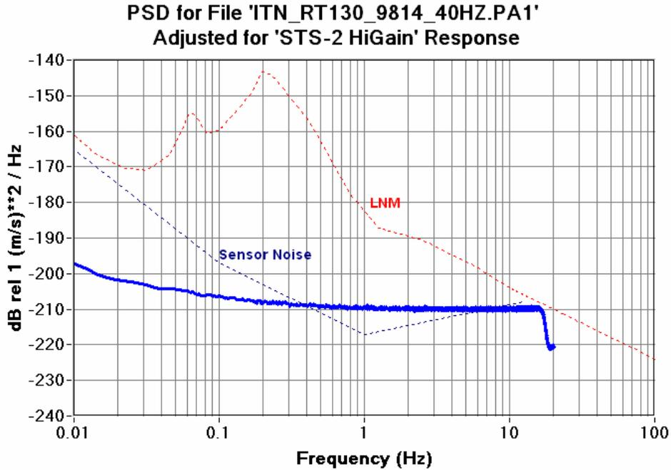
Figure 6.12.4a RT130HR 40SPS CH1 Seismic System Noise STS-2 High Gain
