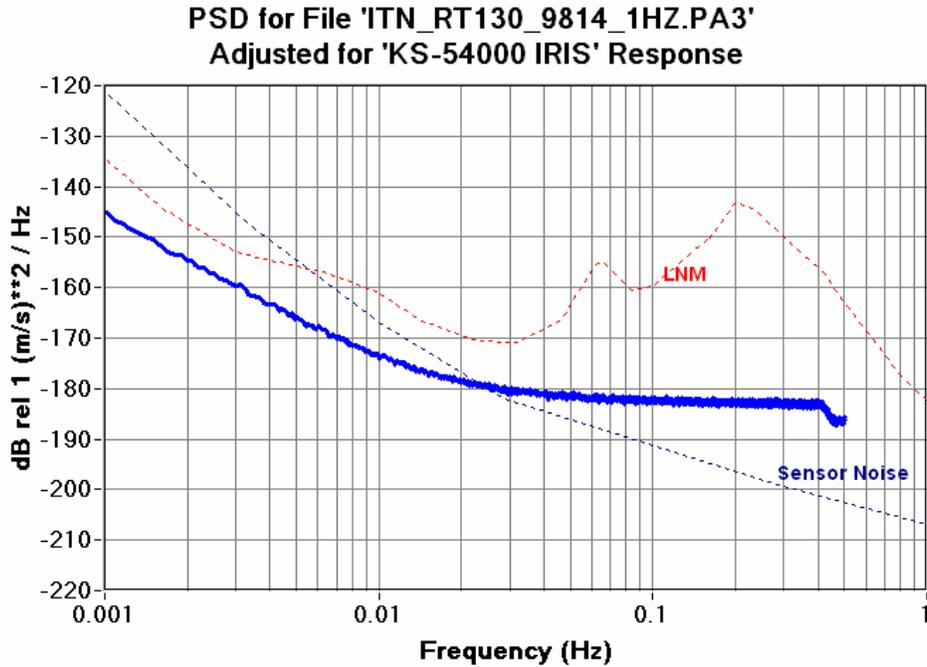
Figure 6.12.12c RT130HR 1SPS CH3 Seismic System Noise KS54000
