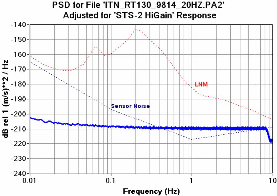
Figure 6.12.7b RT130HR 20SPS CH2 Seismic System Noise STS-2 High Gain
