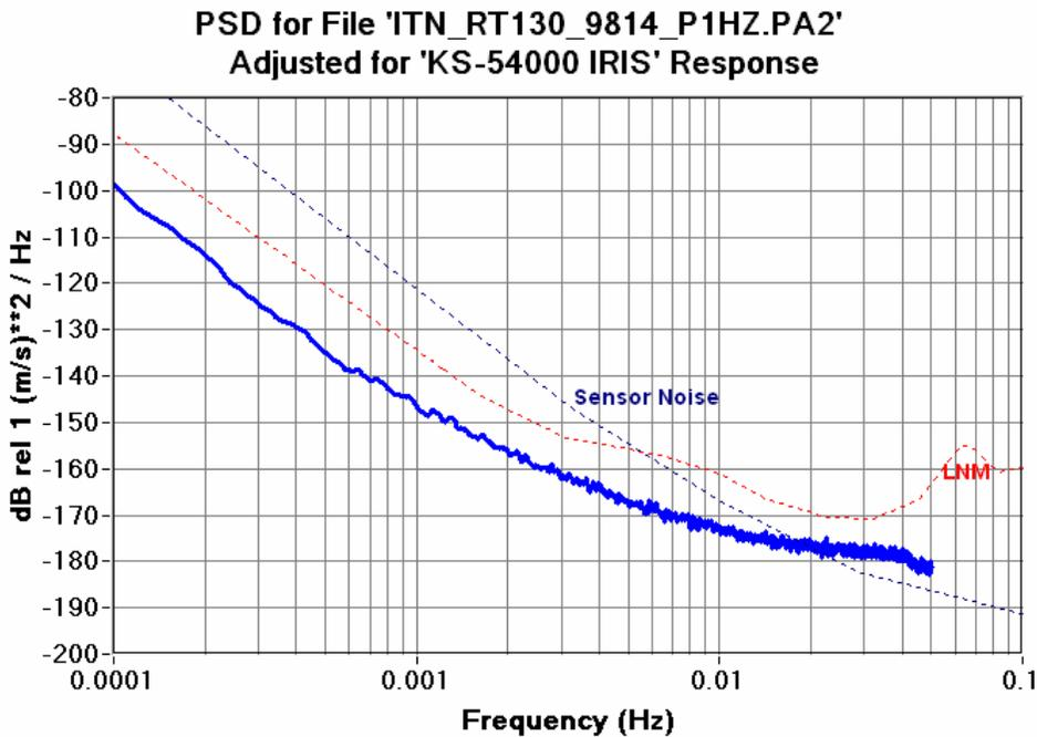
Figure 6.12.17b RT130HR 0.1SPS CH2 Seismic System Noise KS54000
