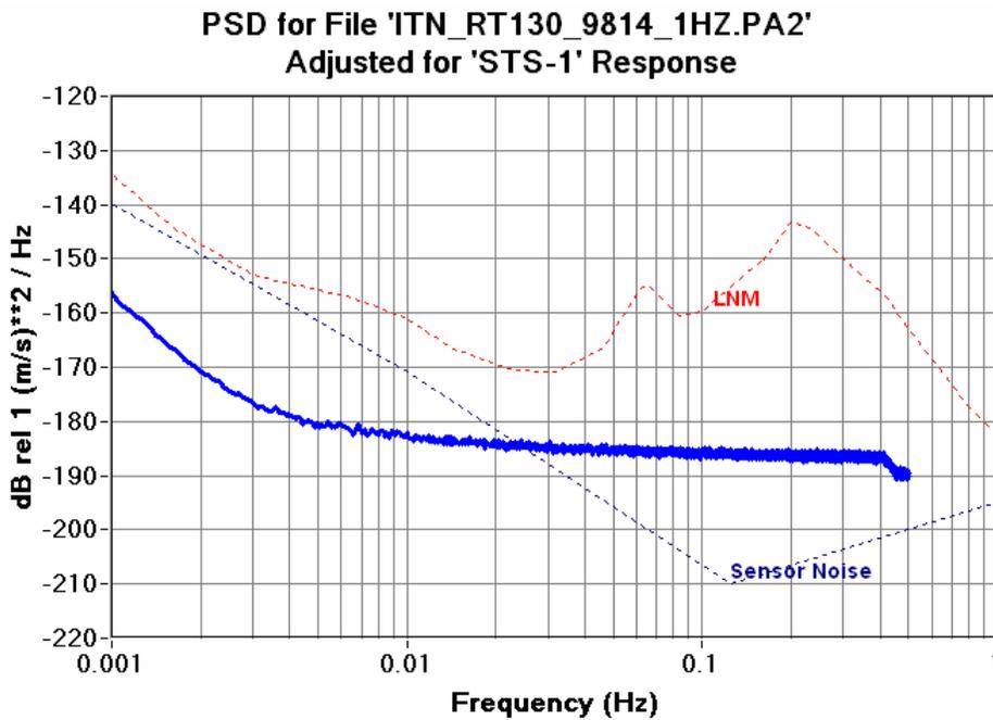
Figure 6.12.11b RT130HR 1SPS CH2 Seismic System Noise STS-1
