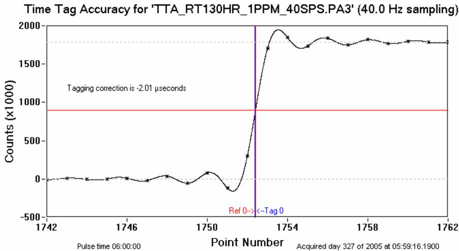
Figure 6.12.4 RT130HR Time-Tag Accuracy
