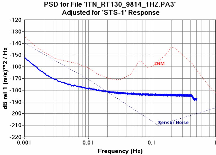
Figure 6.12.11c RT130HR 1SPS CH3 Seismic System Noise STS-1
