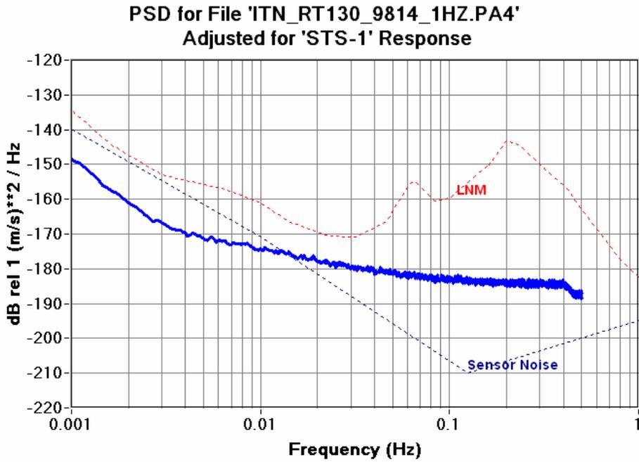
Figure 6.12.13a RT130HR 1SPS CH4 Seismic System Noise STS-1
