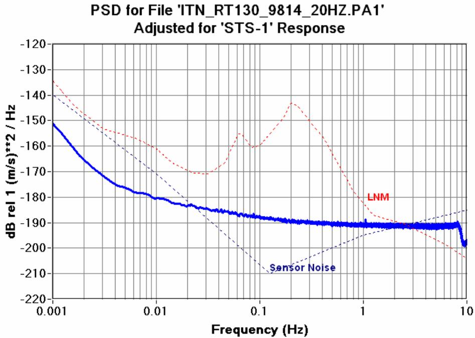
Figure 6.12.9a RT130HR 20SPS CH1 Seismic System Noise STS-1
