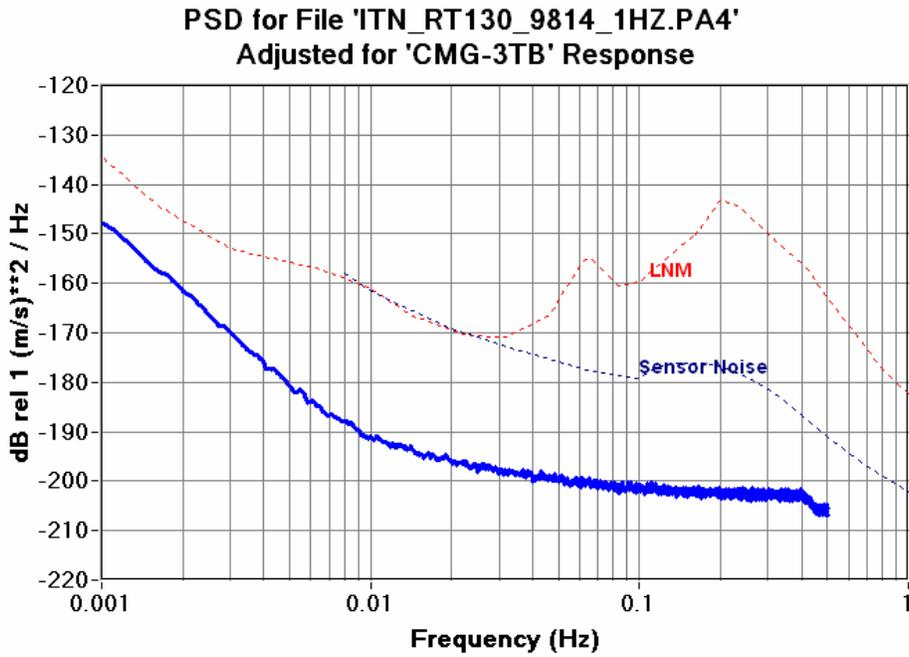
Figure 6.12.15a RT130HR 1SPS CH4 Seismic System Noise CMG-3TB
