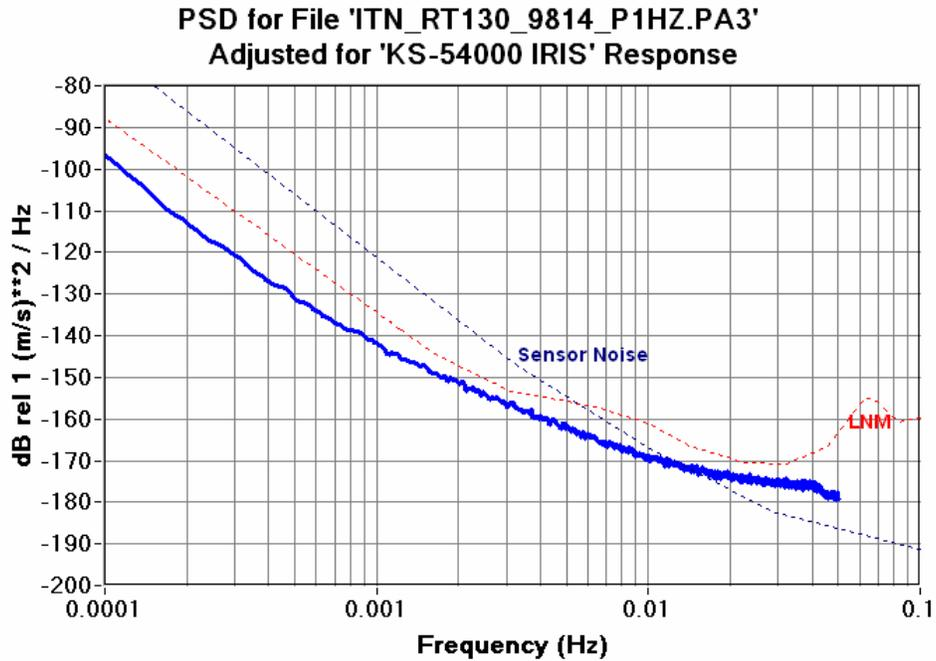
Figure 6.12.17c RT130HR 0.1SPS CH3 Seismic System Noise KS54000
