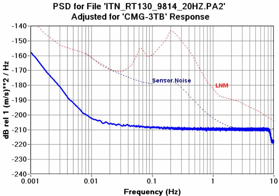
Figure 6.12.8b RT130HR 20SPS CH2 Seismic System Noise CMG-3TB
