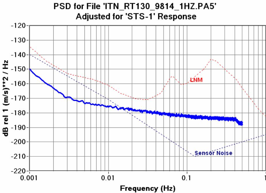
Figure 6.12.13b RT130HR 1SPS CH5 Seismic System Noise STS-1
