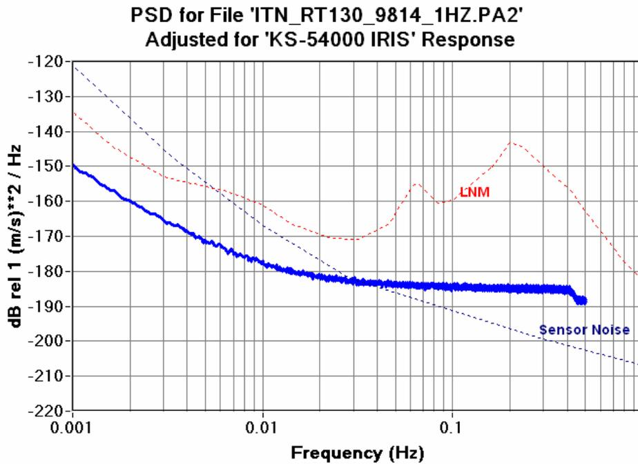
Figure 6.12.12b RT130HR 1SPS CH2 Seismic System Noise KS54000
