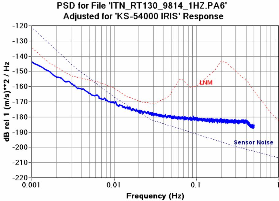
Figure 6.12.14c RT130HR 1SPS CH6 Seismic System Noise KS54000
