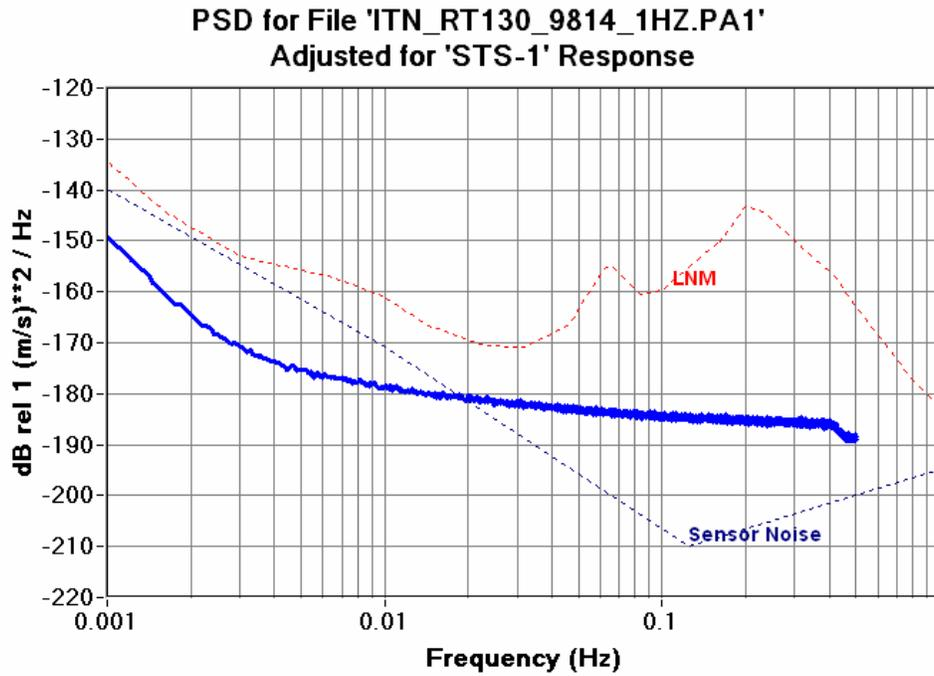
Figure 6.12.11a RT130HR 1SPS CH1 Seismic System Noise STS-1
