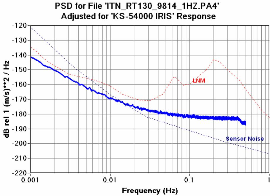
Figure 6.12.14a RT130HR 1SPS CH4 Seismic System Noise KS54000
