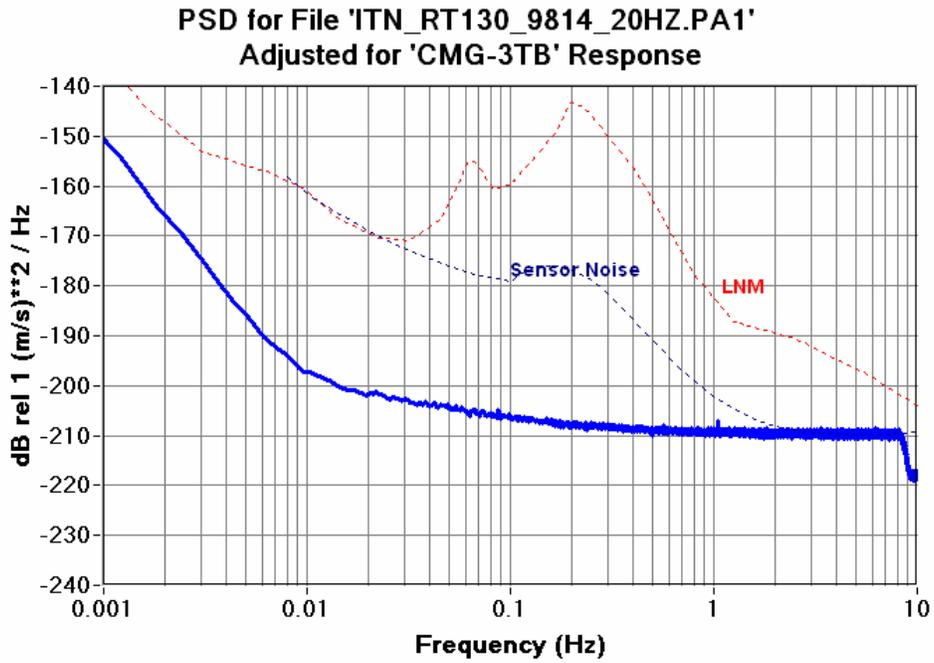
Figure 6.12.8a RT130HR 20SPS CH1 Seismic System Noise CMG-3TB
