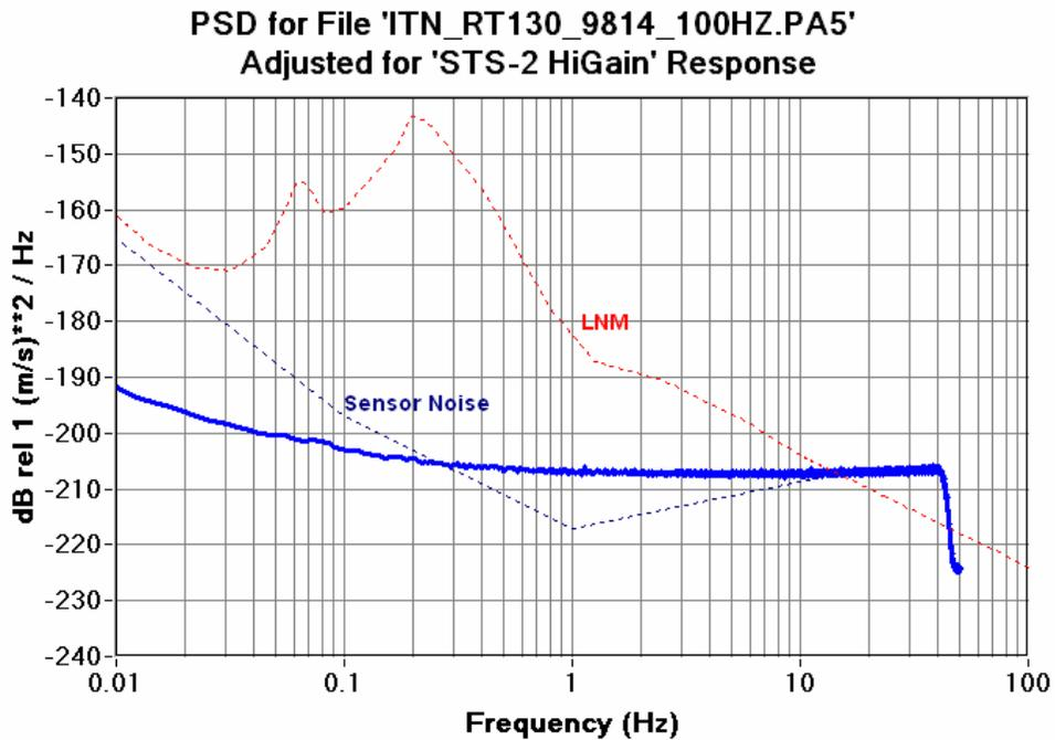
Figure 6.12.3b RT130HR 100SPS CH5 Seismic System Noise STS-2 High Gain
