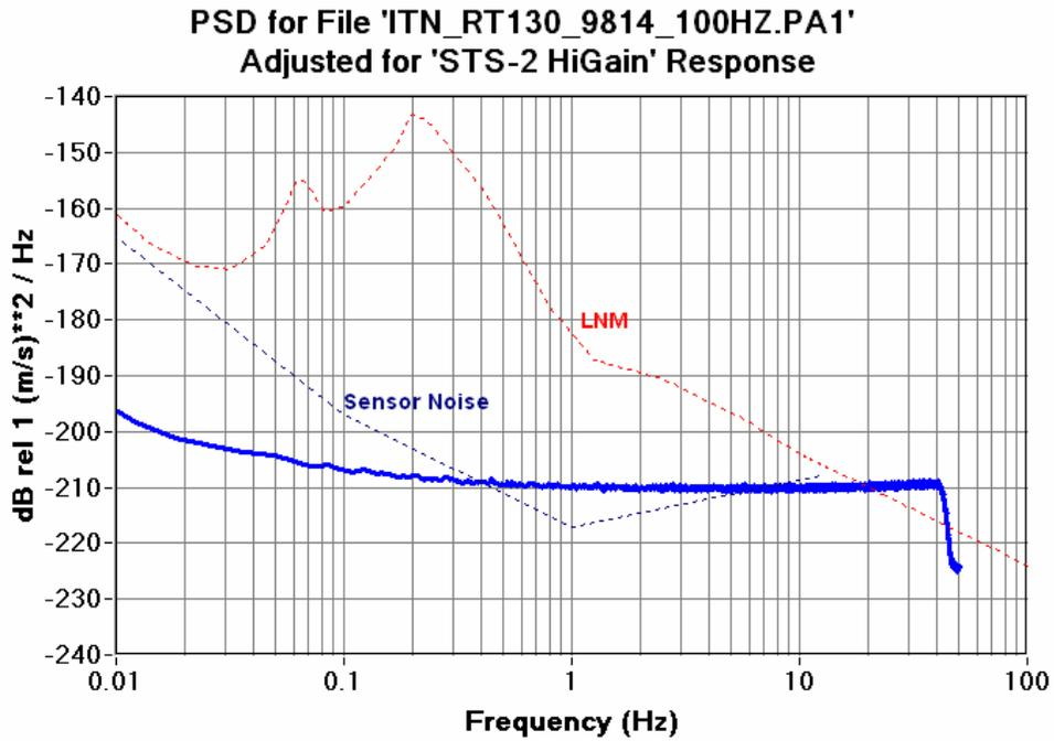
Figure 6.12.2a RT130HR 100SPS CH1 Seismic System Noise STS-2 High Gain
