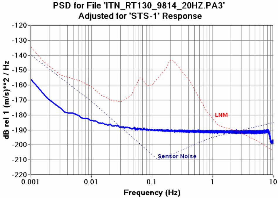
Figure 6.12.9c RT130HR 20SPS CH3 Seismic System Noise STS-1
