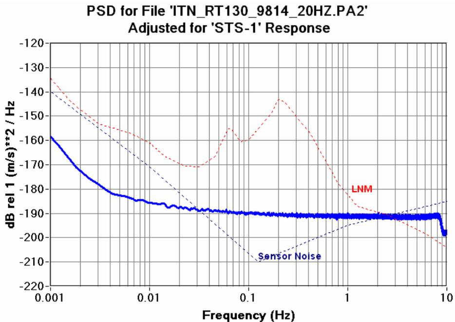
Figure 6.12.9b RT130HR 20SPS CH2 Seismic System Noise STS-1
