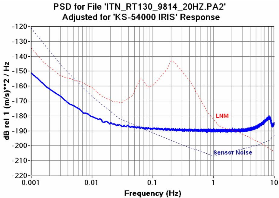
Figure 6.12.10b RT130HR 20SPS CH2 Seismic System Noise KS54000
