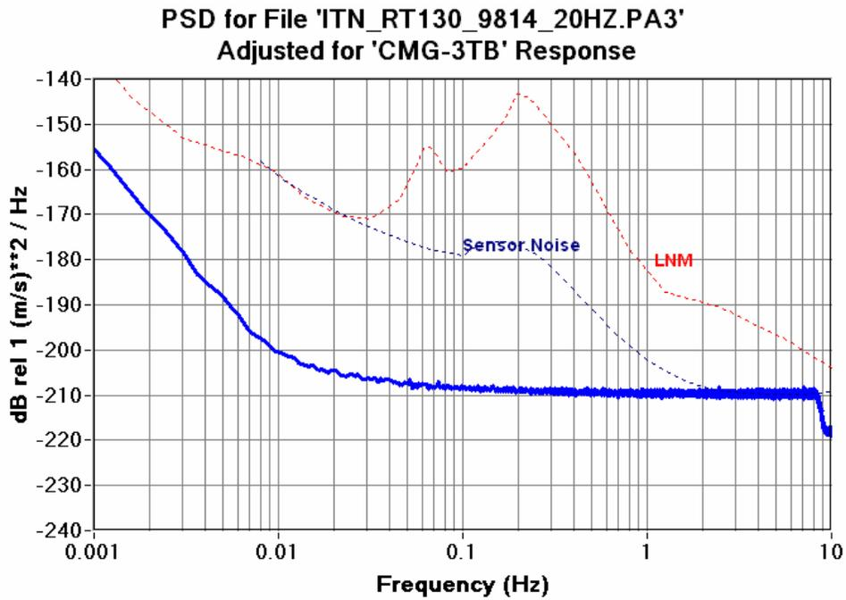
Figure 6.12.8c RT130HR 20SPS CH3 Seismic System Noise CMG-3TB
