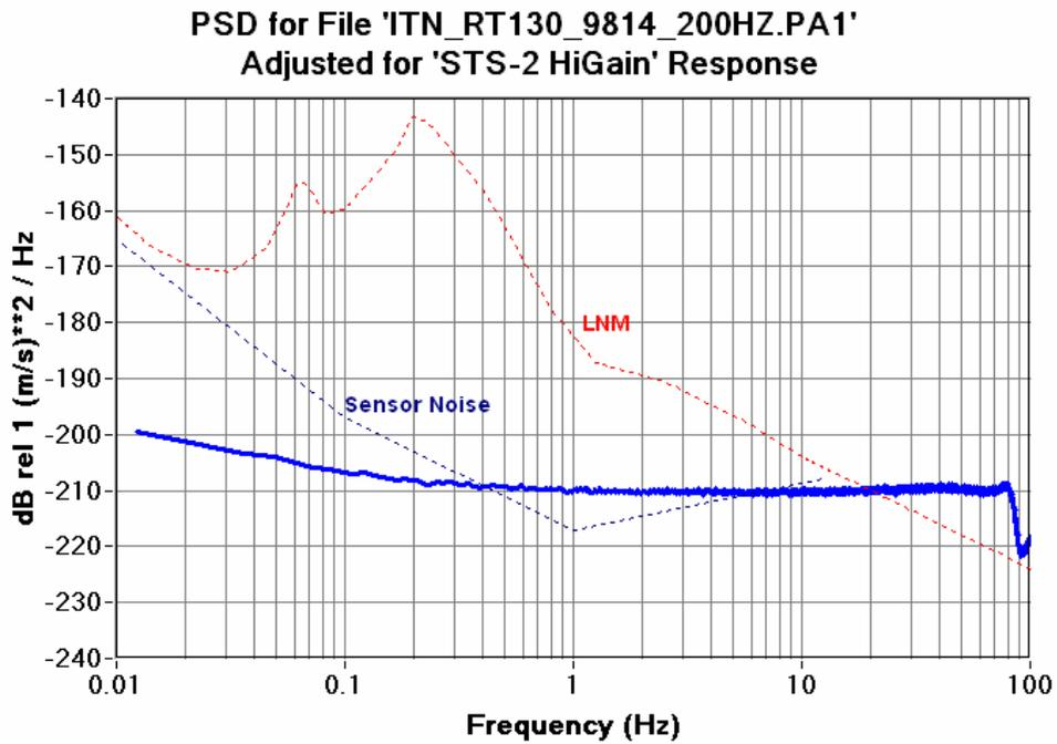
Figure 6.12.1a RT130HR 200SPS CH1 Seismic System Noise STS-2 High Gain
