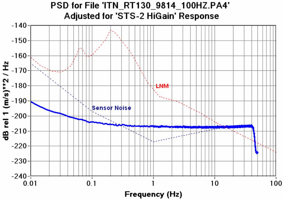
Figure 6.12.3a RT130HR 100SPS CH4 Seismic System Noise STS-2 High Gain
