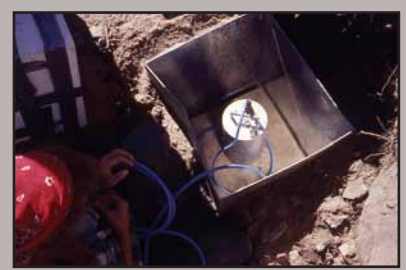
▲ Os sismómetros são instalados em locais protegidos e bem aplainados ao chão.
